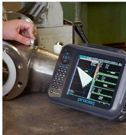
Proceq Flaw Detector 100 - дефектоскоп, сочетающий классический метод УЗК с поддержкой ФР. Подходит как для контроля сварных швов, так и для инспекции сложных геометрических форм, в том числе с картированием коррозии. Также применяется для составления карты коррозии и контроля композитных материалов.
