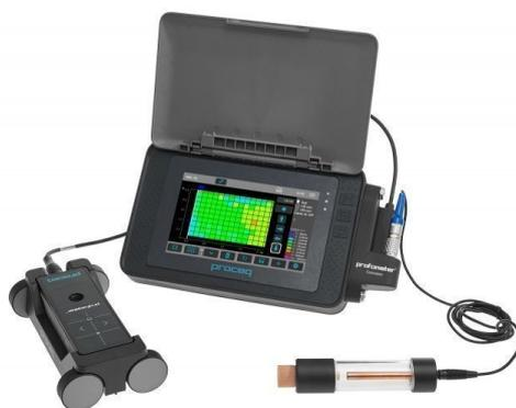
прибор для измерения разности потенциалов полуэлементов для построения карты распределения потенциала на объекте. Программное обеспечение, предназначенное для измерений стержневым и роликовым электродами. Статистическая обработка данных.
